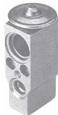
C.88.05.225.A OPEL Vectra B mini block Cod. O.E.M. 90512364/16 18057 Connessioni 8 x 11 - 14 x 17
