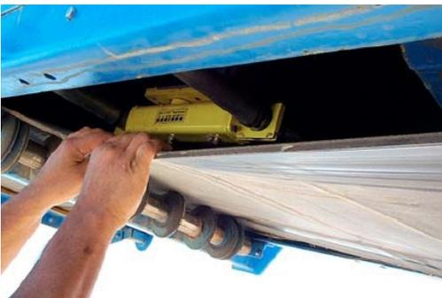
O seu sistema de fixação aos tapetes, através de tubagem galvanizada de 1-1/4", permite que o equipamento seja mudado com facilidade para qualquer outro tapete de capacidade semelhante, mesmo com comprimento diferente.
