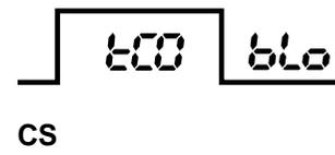
Señal desde el interruptor de ciclos durante el primer reposo de bloqueo → **interrupción funcionamiento de bloqueo**
